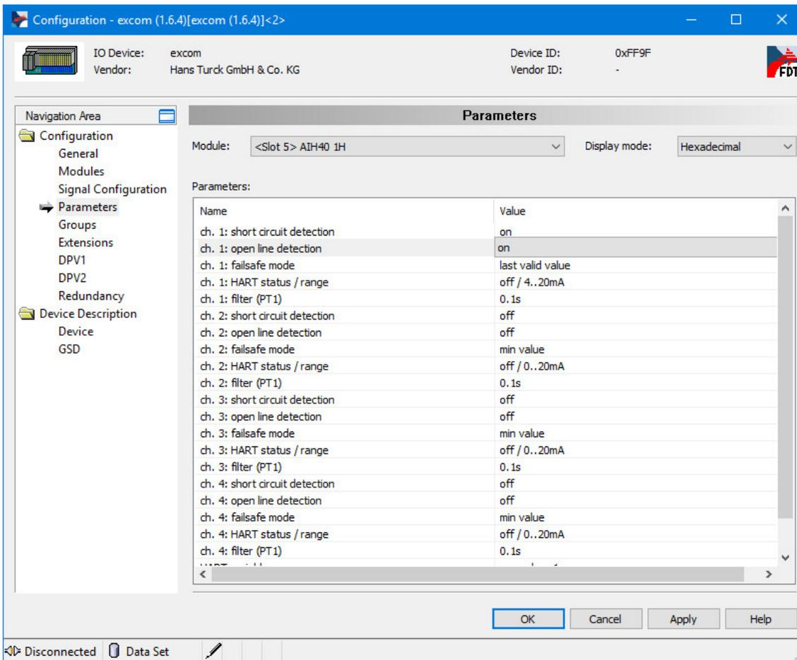
Fig. 11: Setting module-specific parameters
