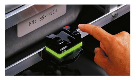
Tast- bzw. Reflexionslichtgitter besonders wirtschaftlich. Es überstrahlt den Bereich vor einer Entnahmebox mit einer Reihe von Lichtstrahlen und erfasst damit sicher die Hand des Monteurs. Das PVD verifiziert die Entnahme automatisch.
