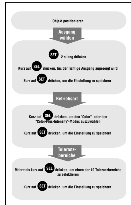
Abb. 2 Kurze Programmieranleitung des QC50 Sensors
