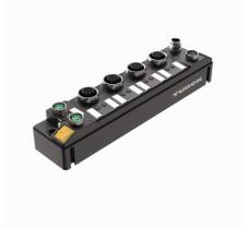
型목 TBEN-S2-4IOL 货号 6814024 系统数据 供电电源 24 VDC 允许范围 18...30 VDC 每个电压组的最大总电流为4A 连接供电电压 2×M8,4针,A型 工作电流 V1:最小50 mA,最大110 mA V2:最小10 mA,最大115 mA 传感器/执行器供电 端口 C0-C3 由 V2 供电 无短路保护, 最大 4 A 用于 C0-C3 组 电气隔离 电压组V1和V2电隔离 , 电压最高500 VAC 系统数据 现场总线传输速率 10/100 Mbps 现场总线连接技术 2个M8,4针 诊断协议 网络服务器 默认: 192.168.1.254 通过 P1 或 P2以太网连接 服务接口 ARGEE功能 支持 Modbus TCP 静态IP,DHCP 地址 支持功能代码 FC1, FC2, FC3, FC4, FC6, FC15, FC16, FC23
