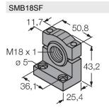
Montagehalterung, PBT-schwarz, für Sensoren mit 18-mm-Gewinde, ausrichtbar
