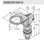
3011185 Montagewinkel, Edelstahl, für 30mm-Gewinde, Gewinde M10 x 1,5
