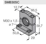
Montagehalterung, PBT-schwarz, für Sensoren mit 30-mm-Gewinde, ausrichtbar
