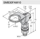
3011185 Montagewinkel, Edelstahl, für 30mm-Gewinde, Gewinde M10 x 1,5
