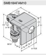
3012558 Montagewinkel, Werkstoff VA 1.4401, für 18mm-Gewinde, Gewinde M10 x 1,5
