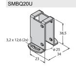
Schutzgehäuse, Edelstahl, für Bauform Q20
