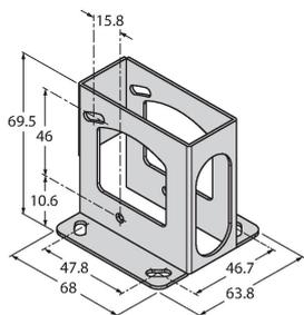
Schutzgehäuse, Edelstahl, für Sensoren der Baureihe LE250/550
