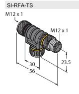
3806409 Zweifach-Verteiler für RFID-Sicherheitsschalter zum Anschluss im Kaskadenverbund
