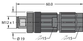
Konfektionierbarer Stecker, M12 x 1, gerade, 5-polig, Push-In-Anschluss, Leitungsdurchlass 4.0 bis 8.0 mm, Adernquerschnitt/Klemmvermögen 0.14 bis 0.75 mm<sup>2</sup>, Kunststoffgehäuse, Metallüberwurfschraube
