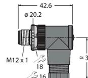
Konfektionierbarer Stecker, M12 x 1, gewinkelt, 12-polig, Lötkontakt, Leitungsdurchlass 6.0 bis 8.0 mm, Adernquerschnitt/ Klemmvermögen 0.14 bis 0.25 mm<sup>2</sup>, Kunststoffgehäuse, Metallüberwurfschraube
