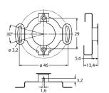
accouplement stator en acier inoxydable pour codeur à arbre creux, diamètre primitif de référence 46 mm, pour les applications à jeu axial et radial avec dynamique élevée
