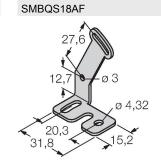
équerre de montage, acier inoxydable, pour filetage 18 mm
