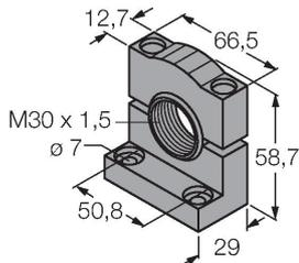
bride de fixation, noir PBT, pour les détecteurs à filetage 30 mm, orientable
