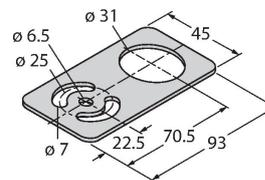
plaque de montage, acier inoxydable, pour les détecteurs à filetage 30 mm
