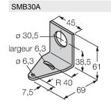
équerre de montage, coudée, acier inoxydable, pour les détecteurs à filetage 30mm
