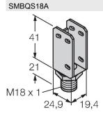
équerre de montage, acier inoxydable, pour filetage 18 mm
