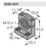
3052519 bride de fixation, noir PBT, pour les détecteurs à filetage 18 mm, orientable
