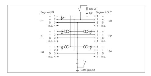
Le répartiteur à quatre canaux du type JBBS-49SC-E413/3G est conçu pour le FOUNDATION™ fieldbus.
