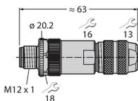
Connecteur male confectionnable, M12 x 1, droit, 8 pôles, raccordement par borne à vis, diamètre de ligne 6.0 à 8.0 mm, section conducteur/section raccordable 0,14 à 0.50 mm<sup>2</sup>, boîtier métallique, écrou de montage métallique, peut être blindé, e.a. pour Ethernet
