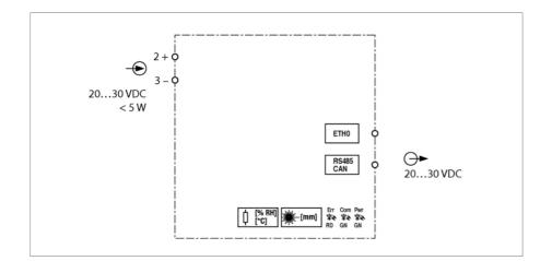
Модуль защиты электрошкафа IM18-ССМ40-MTI/24 В пост. тока отслеживает температуру, относительную влажность и расстояние от дверцы шкафа управления с помощью встроенных датчиков. Например, информацию можно передать в системы более высокого уровня через интерфейс Ethernet.
