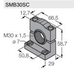
3052521 Монтажный зажим, РВТ черн., для датчиков с резьбой 30 мм, поворотный
