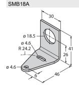
3033200 Кронштейн, прямоугольный, нерж. сталь, для датчиков с резьбой 18 монтажный зажим, черный, M22 x1.5 мм, внешняя резьба, внутренняя резьба M18 x 1, для датчиков с резьбой M18
