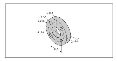
Стандартная проставка из неферритового материала для отделения позиционирующего элемента от основания штока гидравлического поршня
